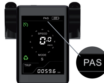
Koloběžka je v režimu asistovaného startu, což znamená, že pro aktivaci plynu musíte na začátku nabrat určitou rychlost.
