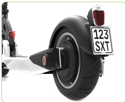
Bezkomutátorový nábojový motor v zadním kole / funkce automatického vypnutí
